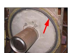
Figure 5-7 Burner door gasket
