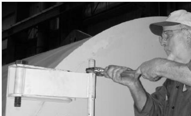
**Figura 5-8 Apriete la tuerca en el brazo pescante antes de abrir la puerta**
