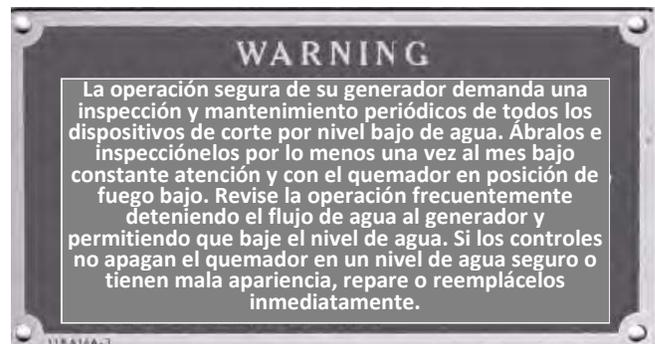
**Figura 5-2: Corte por nivel bajo de agua (LWCO)**
