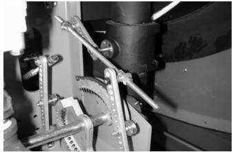
1. ADJUST THE LINKAGE TOWARD THE DRIVE SHAFT FOR LESS MOVEMENT.
