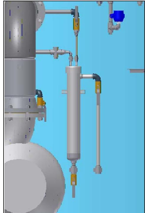
Figure 6 - Refroidisseur d'échantillon
