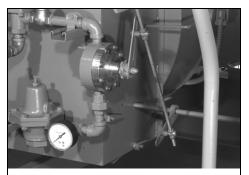
ADJUST THE LINKAGE TOWARD THE DRIVE SHAFT FOR LESS MOVEMENT. ADJUST AWAY FROM THE DRIVE SHAFT FOR MORE LINKAGE MOVEMENT.
